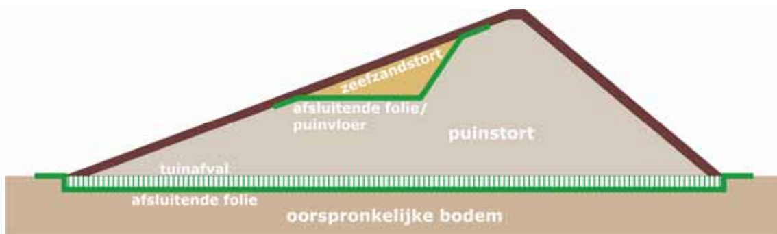
Figuur 4.1: Schematische dwarsdoorsnede puin- en zeefzandstort
